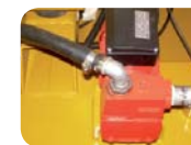
Pompe automatique de remplissage réservoir
