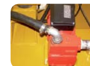
Pompe automatique de remplissage réservoir
